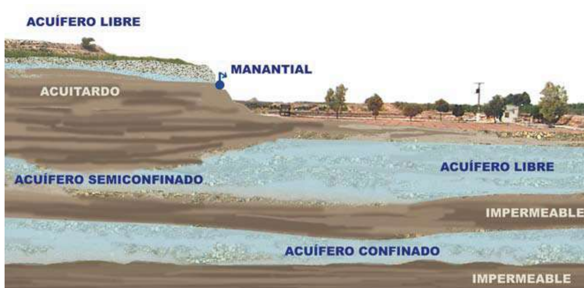
Figura 12.6. Tipos de acuíferos en función de la presión hidrostática del agua contenida en ellos (IGME; 2009).
