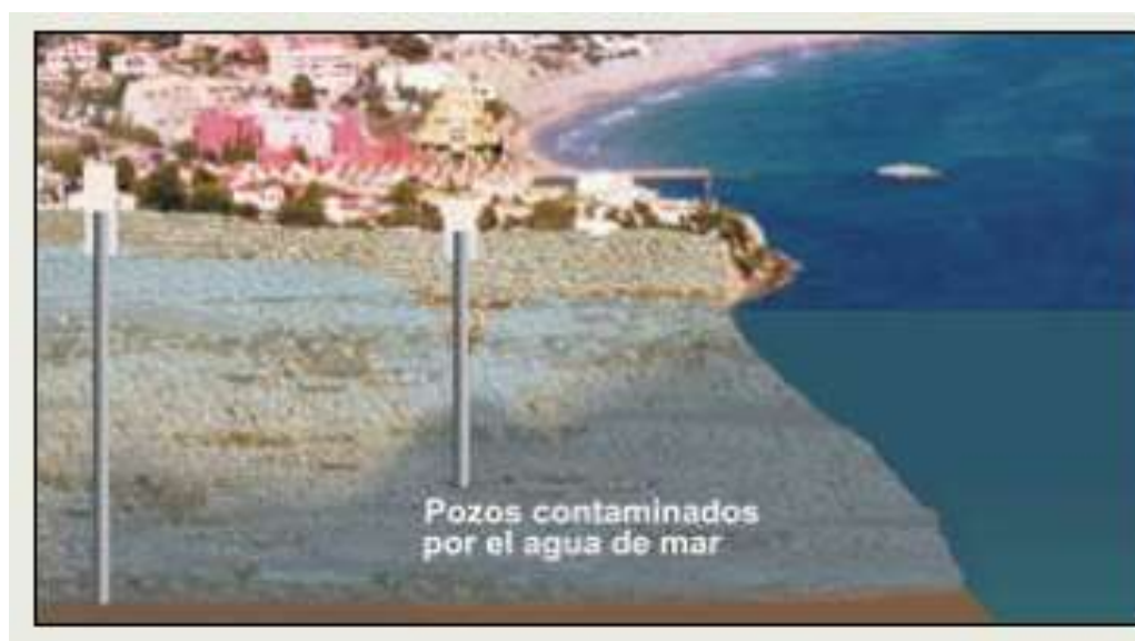
Figura 12.15. Contaminación de agua subterránea por intrusión marina en sondeos próximos a la costa (IGME, 2009).
