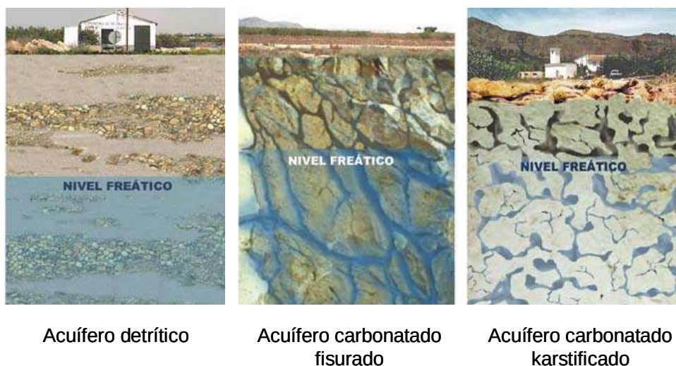
Figura 12.5. Tipos de acuíferos en función de sus características litológicas e hidrogeológicas (Modificado de IGME; 2009).
